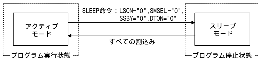
図2 スリープモードへの遷移におけるモード遷移図
